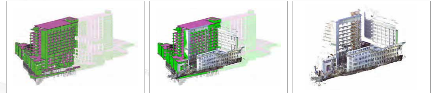
Landesklinikum Graz: Planung des Neubaus und Bestand (blauer Teil) | Planung inklusive 3D-Punktwolke zur Kontrolle der Ausführung | 3D-Punktwolke und umliegende Gebäude (Visualisierungen Lorenz Consult)
