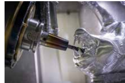
In knapp 13 Stunden entstand dieser etwa 500 mm lange Panther aus einem Aluminiumblock.
