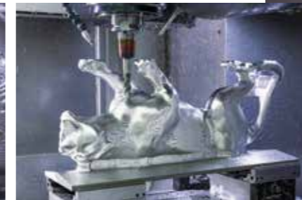
In knapp 13 Stunden entstand dieser etwa 500 mm lange Panther aus einem Aluminiumblock.
