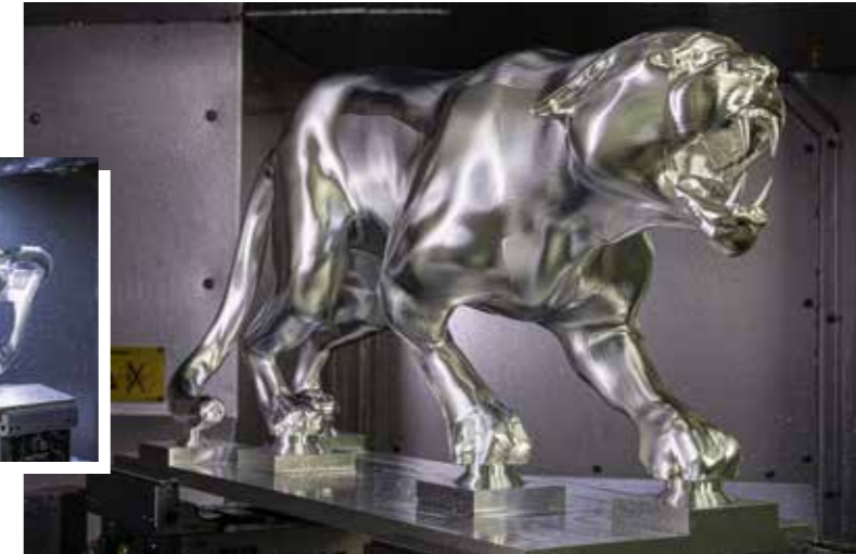
In knapp 13 Stunden entstand dieser etwa 500 mm lange Panther aus einem Aluminiumblock.
