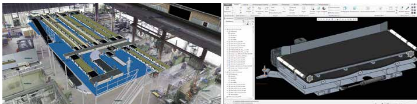
Elegant kombiniert: Die neue, im 3D-CAD konstruierte Verpackungsstraße und die Aufnahmen des 3D-Laserscanners.
