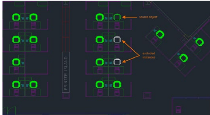
Schlaues AutoCAD: Werden in einer Zeichnung mehrere gleichartige Geometrien gefunden, macht die Software automatisch Blöcke daraus.
