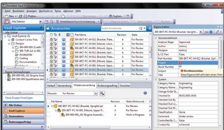
Die Autodesk-PDM-Systeme kontrollieren die Einhaltung von Werkvorschriften und -regeln hinsichtlich der Zeichnungsnummerierung, der Teilebezeichnungen, Kategorien und Abläufe.
