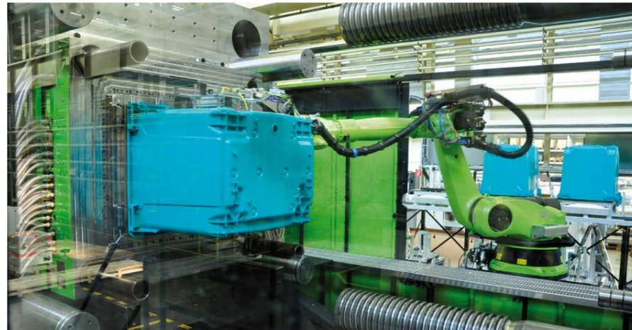
Die Kernseite mit dem Formteil ist frei zugänglich, was die Übernahme des Behälters durch den Handlingroboter erleichtert. © Haidlmair GmbH
