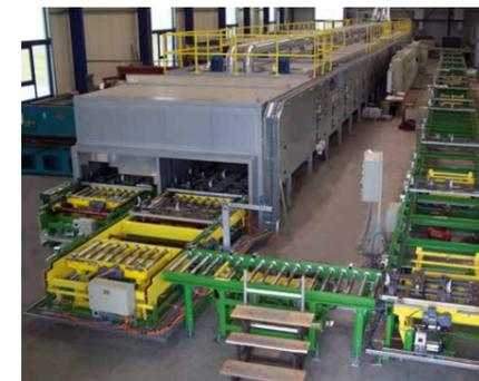
Trocknungsanlage für Gießformen von Pkw-Motorblöcken. © Elpo GmbH
