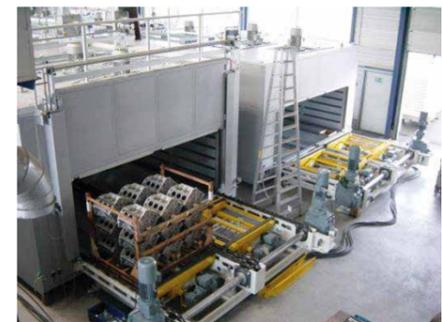
Wärmebehandlungsanlage für Pkw-Motorblöcke. © Elpo GmbH
