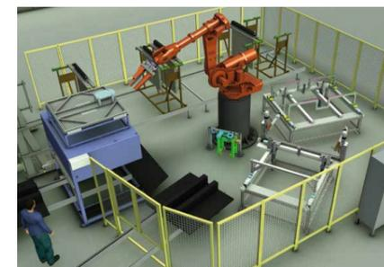
Central Interface zum Handling von Lkw-/Pkw-Kühlern (Konstruktion mit Autodesk Inventor, Rendering mit Autodesk 3ds Max). © HÖRMANN RAWEMA Engineering & Consulting GmbH
