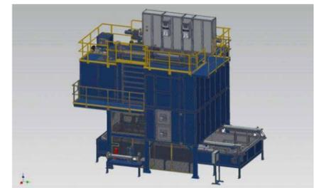
Anlage zum Abschrecken und Trocknen von sicherheitsrelevanten Karosseriebauteilen. © Elpo GmbH
