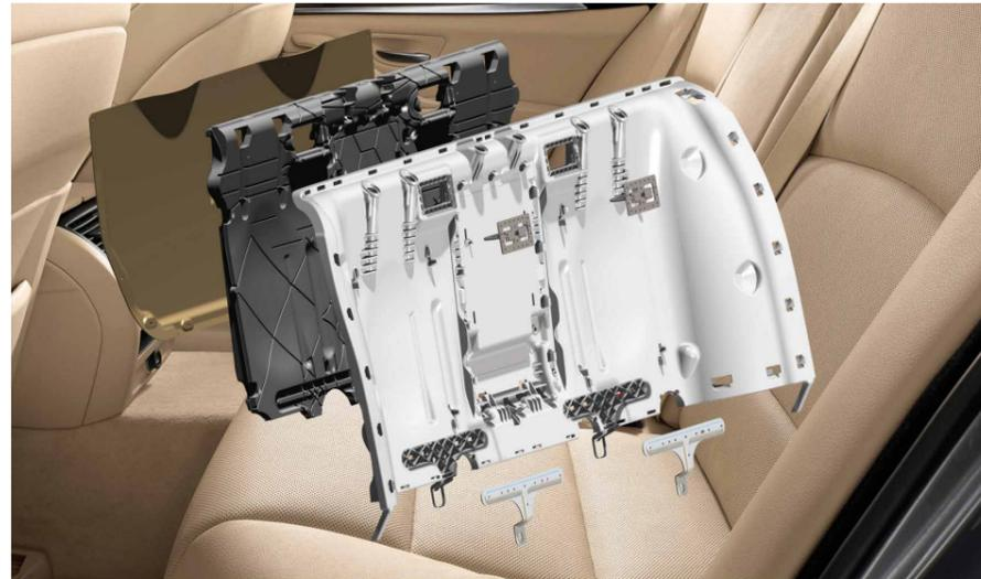
Die Sandwich-Lehne in Explosionsdarstellung bestehend aus Spritzgussbauteil, EPP-Schaum und Teppich (von vorne nach hinten). © BMW Group
