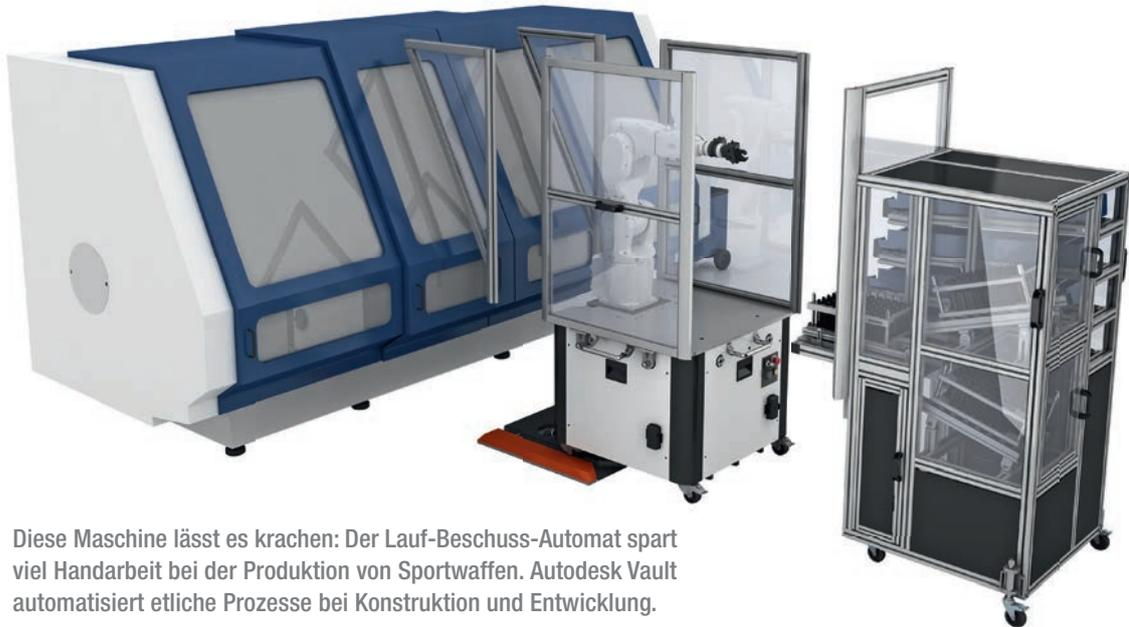
Diese Maschine lässt es krachen: Der Lauf-Beschuss-Automat spart viel Handarbeit bei der Produktion von Sportwaffen. Autodesk Vault automatisiert etliche Prozesse bei Konstruktion und Entwicklung.
