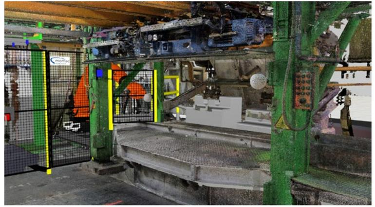
momac Schlackeroboter schöpfen die bei der Stahlbandveredelung entstehende Schlacke automatisch von Zinkbädern ab. Der Zinkverbrauch wird reduziert, Kunden sparen Kosten.
