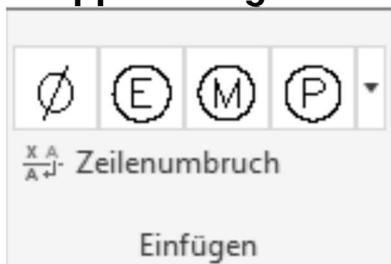
In dieser Gruppe finden Sie sämtliche Sonder- und Spezialzeichen, die Sie dem Maßtext zuweisen können. Achten Sie darauf, dass der Cursor am Maßtext an der Stelle positioniert wird, an der das Symbol eingefügt werden soll.
